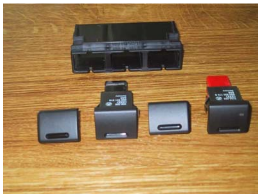
Figur 12. Originaldelar till strömbrytare för att ersätta befintlig mugghållare i mittkonsolen. Från vänster till höger: blindlock 8D0 941 515, blindlock mitten polis 8D0 941 518, blindlock 8D0 941 516 samt strömbrytare komradio utan symbol 8D0 035 775 B. I bakgrunden infästning för strömbrytare 8D0 035 775 B.
