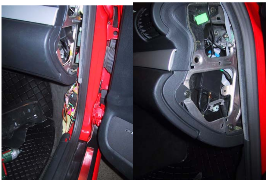
Figur 11. Montering av modifierad ActiveGPS bakom bilens handsfack, men åtkomlig via luckan på instrumentbrädans passagerarsida. Med denna montering av ActiveGPS krävs cirka 2.5 meter antennkabel för GPS-antennen vid montering av denne vid hatthyllan. Till vänster: närbild av monteringen.
