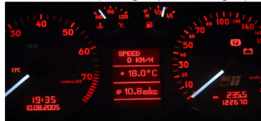
Figur 1. Information från ActiveGPS visas i bilens färddatordisplay FIS med hjälp av EFU. Vid larm från ActiveGPS visas SPEED WARNING (övre vänster – kommer att ersättas av SPEED CAMERA ). EFU visar normalt kalibrerad hastighet digitalt SPEED 0 KM/H (övre högra bilden), eller annan information som turbotryck, oljetemperatur, med mera. Hela kombiinstrumentet från en Audi S4 visas i den nedre figuren.
