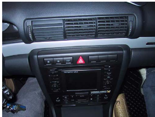
Figur 2. Styrning av ActiveGPS sker via strömbrytare i bilens mittkonsol. Strömbrytaren (längst till höger) saknar symbol och har en röd indikeringsdiod som indikerar då ActiveGPS är i uppstartsläge eller har tappat kontakt med satelliterna. Övriga strömbrytare är (från vänster till höger): dimljus, dimljus, ESP, varningsblinkers, blindlock, blindlock, ActiveGPS.
