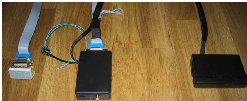
Figur 8. Vidare förädling av ActiveGPS. LED-display (för teständamål) ansluten via bandkabel (till vänster), ActiveGPS med kabelstrumpor monterade (mitten), samt den modifierade strömbrytaren monterad i dess infästning. Notera att figuren visar ett komplett (lågpris) system för integrering i Audi utan EFU – original Audi-strömbrytare samt fristående display som monteras på lämpligt ställe.
